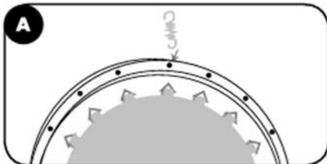
В. Поверните пружину в направлении батута (Рисунок В)
