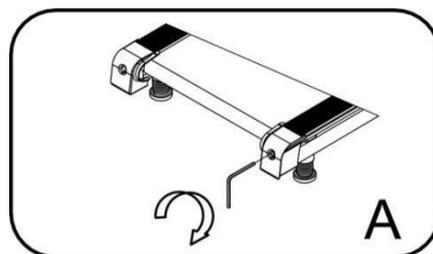
Если лента смещена влево, снимите крышку и поверните левый регулировочный болт на 1/4 оборота по часовой стрелке. Затем попробуйте пробежаться. Если лента все еще смещена, продолжайте настройку. **Рисунок В**
