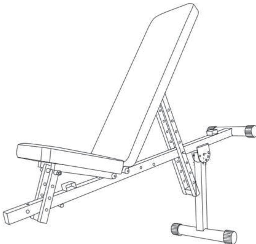
**Шаг 2:** закрепите мягкую регулируемую накладку, используя 1 гайку M8 и 1 шайбу M10.
