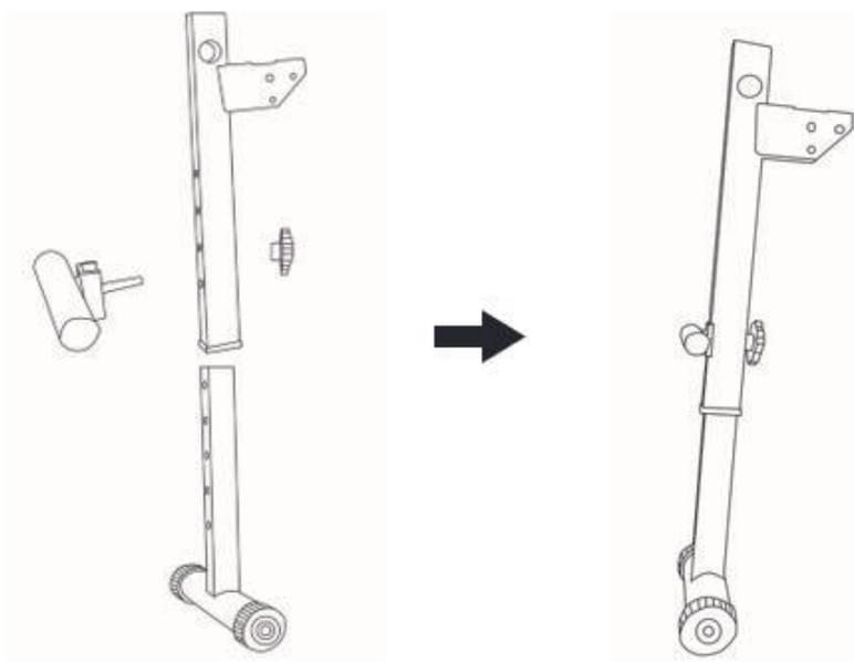
**Шаг 3:** вставьте переднюю опору в основную раму, используя 1 винт M8X55, 1 гайку M8 и 1 шайбу M10. Затем используйте 1 винт M10X55, 2 шайбы M10 и 1 гайку M10 для регулировки положения.
