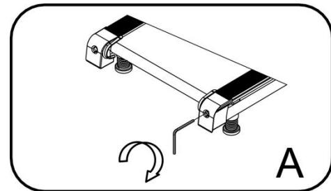
② Если полотно сместилось влево, вытащите предохранитель и переключатель, поверните левый регулировочный болт на 1/4 оборота по часовой стрелке, затем запустите полотно и проверьте его центровку. Продолжайте регулировку до тех пор, пока полотно не будет двигаться строго по центру, см. **РИСУНОК – В.**
