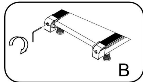
③ Отрегулируйте полотно по прошествии некоторого периода использования. Вытащите предохранитель и переключатель, поверните левый и правый регулировочные болты на 1/4 по часовой стрелке, затем запустите полотно и проверьте его центровку. Продолжайте регулировку до тех пор, пока полотно не будет двигаться строго по центру, см. **РИСУНОК – С.**
