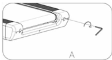
2. Если движущееся полотно смещается влево, поверните регулировочный болт с левой стороны на  $\frac{1}{4}$  поворота по часовой стрелке, затем поверните регулировочный болт с правой стороны на  $\frac{1}{4}$  поворота против часовой стрелки. Если полотно не двигается, повторите данный шаг до полной отцентровки. См. схему В.
