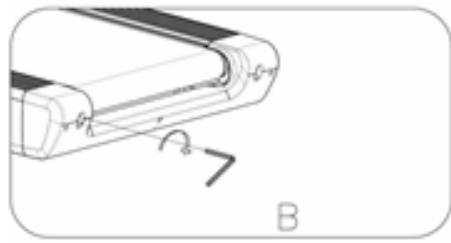
3. Со временем натяжение бегового полотна слабнет. Для натяжения полотна повернуть правый и левый регулировочные болты на один полный оборот по часовой стрелке, затем проверить натяжение полотна. Продолжать процесс до нужного натяжения. Следить за симметричностью действий, чтобы не сместить полотно в сторону. См. рис. С.
