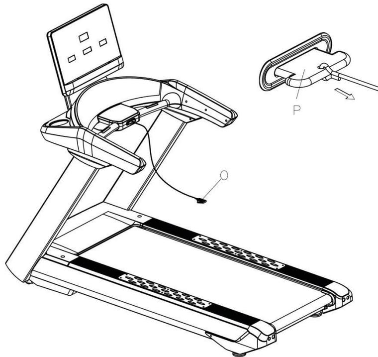
ШАГ 10: Используйте гаечный ключ 22# (J) для регулировки шестигранной головки (O) на винте задней подножки, чтобы отрегулировать устойчивость тренажера.
