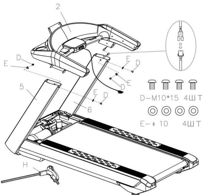
ШАГ 5: С помощью шестигранного Т-образного ключа (Н) прикрепите компьютер (3) к поручню (2) с помощью болта М8\*15 (А) и плоской шайбы Ф8 (В). Затем подключите контактный провод.
