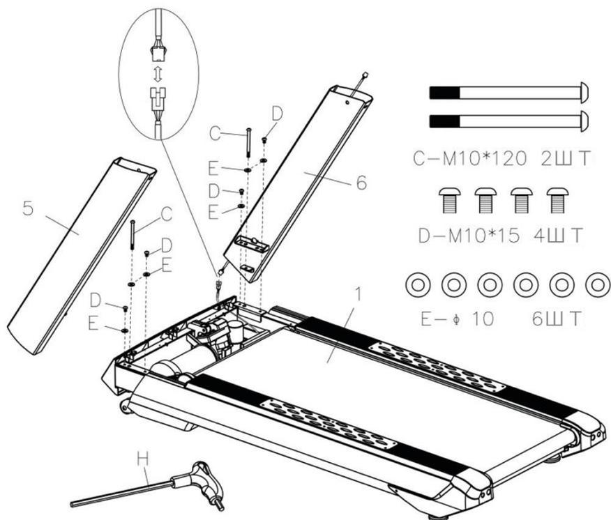
ШАГ 4: С помощью шестигранного Т-образного ключа (Н), болтов М10\*15 (D) и плоских шайб Ф10 (Е) слегка зафиксируйте поручень с держателем компьютера (2) на левой и правой стойках в сборе. Подсоедините контактный провод.
