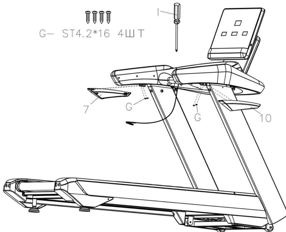
ШАГ 8: С помощью крестовой отвертки (I) и винтов ST4.2\*16 (G) зафиксируйте внутренний кожух (Л) (8) и внутренний кожух (П) (9) на внешнем кожухе (Л) (7) и внешнем кожухе (П) (10) стоек.
