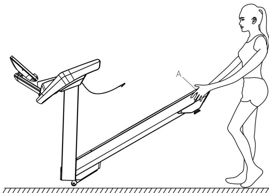
Перед перемещением тренажера отключите кабель питания. Возьмитесь обеими руками за раму А с обеих сторон (как показано на рисунке выше), поднимите машину примерно на 40 градусов, чтобы два передних транспортировочных колеса коснулись земли. После этого вы можете толкать машину вперед или тянуть ее назад.
