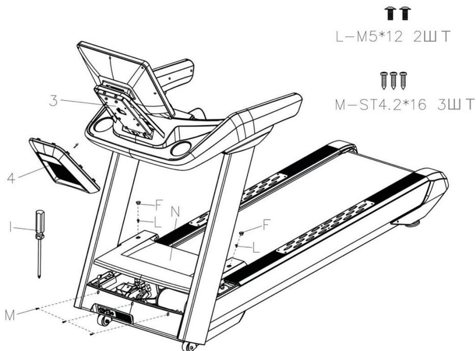
ШАГ 7: С помощью крестообразной отвертки (I), а также снятых винтов М5\*12 (L) и ST4.2\*16 (M) зафиксируйте крышку двигателя (N) и установите заглушку (F).
