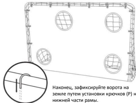
Наконец, зафиксируйте ворота на земле путем установки крючков (Р) на нижней части рамы.
