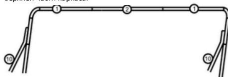
4 Помните, что по мере сборки каркаса необходимо продевать каждый новый элемент в петлю на краю сетки. В конечном итоге, сетка должна свисать с верхней части каркаса и нижним концом быть закреплена на задней части.
