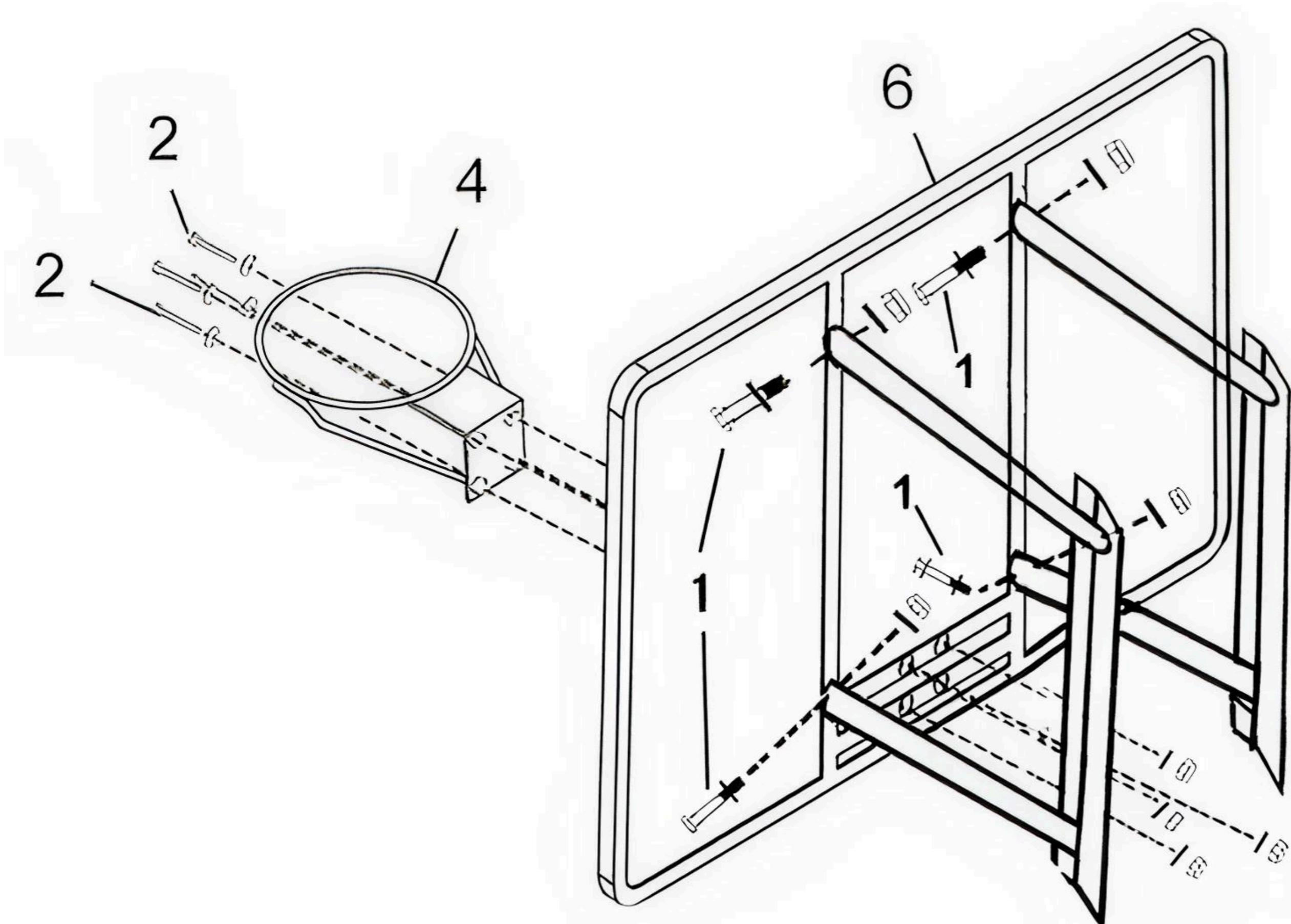
Установите кольцо (4) на щите (6) с помощью 4 болтов (2), также прикрепите кронштейн (7) на щит (6) с помощью болтов (1) как показано на рисунке.
