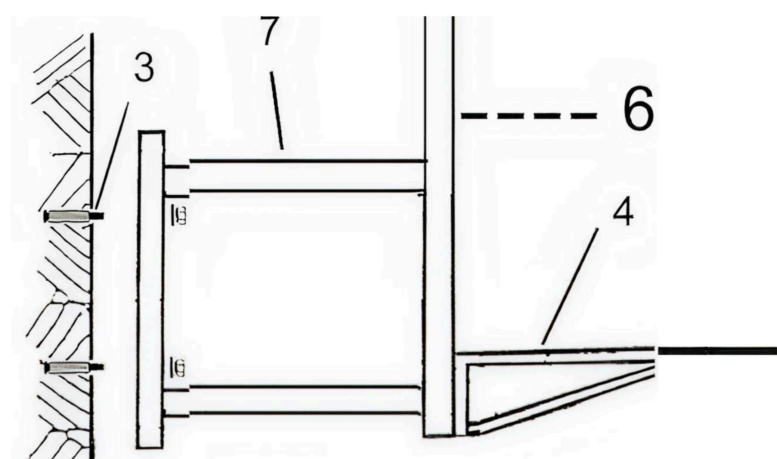
Зафиксируйте кронштейн (7) анкерными болтами (3) на стене как показано на рисунке.
